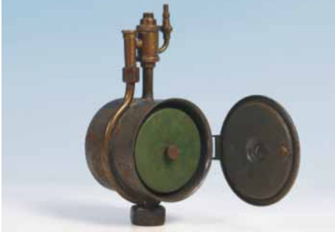
Reloj para el encendido de las antiguas farolas de gas. (Fondo municipal).
