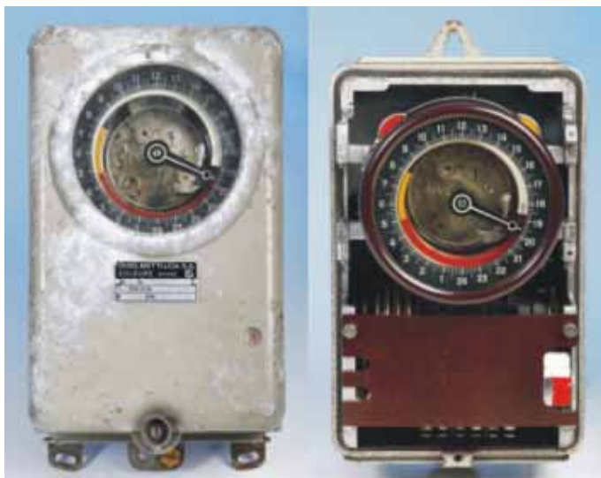
Modelos de relojes astronómicos electromecánicos para el control de encendido del alumbrado público en Gijón. Funcionaron a mediados del siglo XX. (Fondo municipal).
