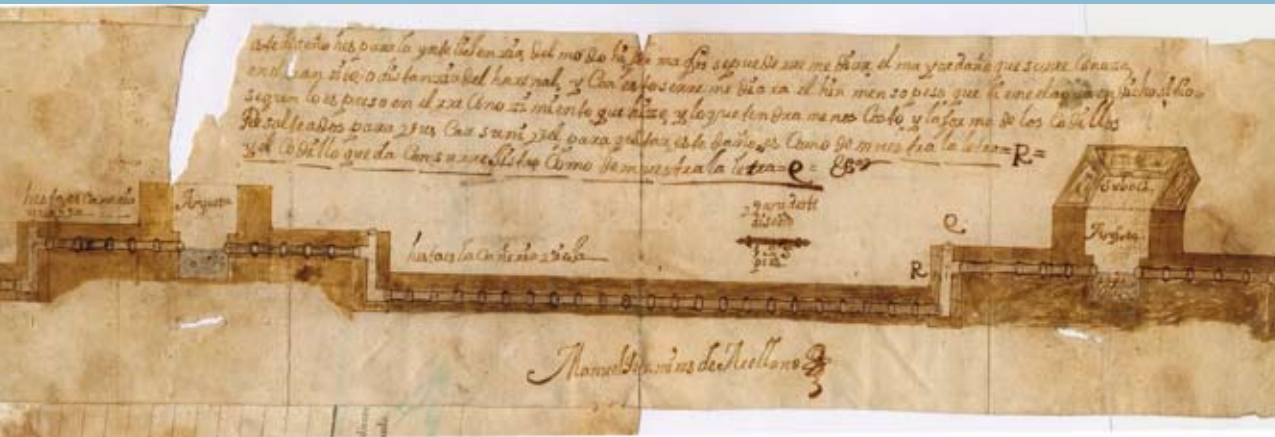
Proyecto de reforma de un tramo de la traída de La Matriz
