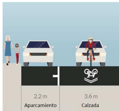
Ilustración 2. Anchuras recomendadas para vías unidireccionales compartidas entre ciclistas y vehículos a motor
