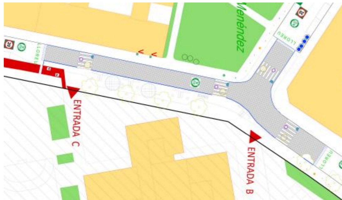
Ilustración 92. Actuación de plataforma elevada a la entrada de centro escolar. Fuente: Memoria EES
